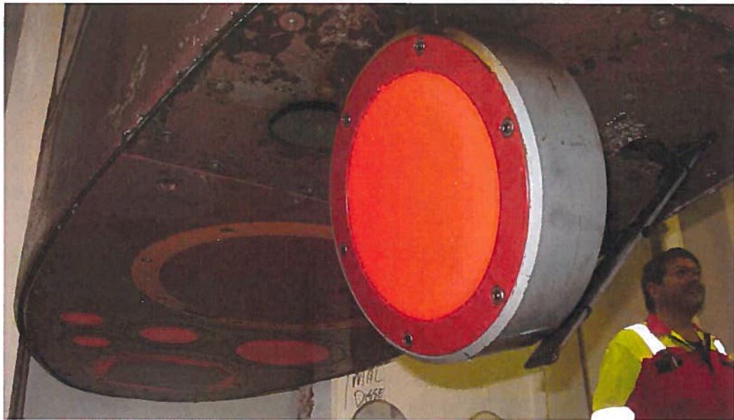
Fig. 12 Ny ES200 3C svinger, montert under senkejølen på G.O.Sars. Denne svingeren har også standard 30 m splittstråle kabel, og kan trekkes gjennom senkejølen uten skjøting.
