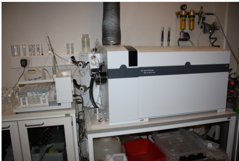
Figur 4. A) Samleprøve av 100 lus i et eppendorfrør før og etter oppslutning i et 15 ml falcon rør, B) 8800 ICP-MS Triple Quad instrumentet.
