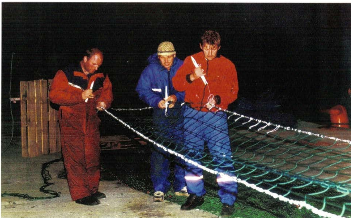
Bilde 2. Produksjon av horisontalt skillepanel til montering i forlengelse på snurrevad. Mannskap på M/S "Svein Frode", Svartneshamna, september 1998.
