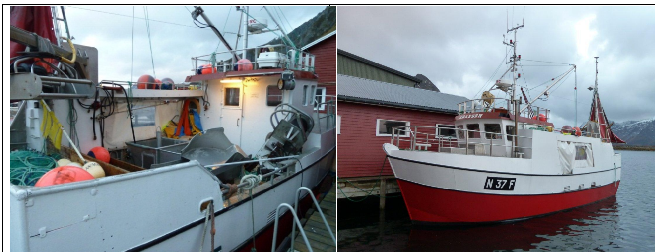
Bilde 10 Kystsjørk 35 fot – type Finnvik aluminium - rigget for torskefiske med garn.
