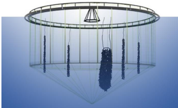
Taresylinder -10 loddrette remser med tareskog montert ved siden av hverandre i en sirkel og knyttet sammen i bunnen- (såkaldt LerøyVest design)
