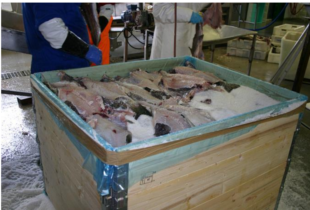
Figur 2.2. Tørرسالting på pall med karmanordning
