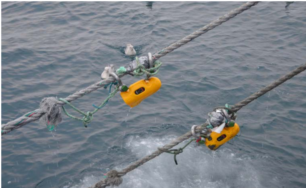
Bilde 3. Geometrisensorer montert ca 1,5 meter foran vingespissene på snurrevadnota. Sensorene festes på sveipene ("grinda") ved hjelp av to store sjakler. For å hindre at sensorene sklir nedover sveipene, benyttets det en stopper midt mellom sjaklene.
