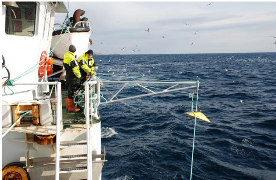
Bilde 2. Utriggerbom for tauing av slepemikrofon (hydrofon montert i "V-fin" paravan)
