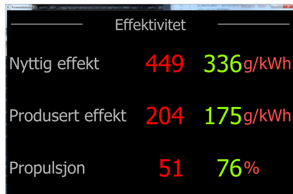
Figur 12: Ombordverktøy: Visning av potensiale for sparing av drivstoff.
