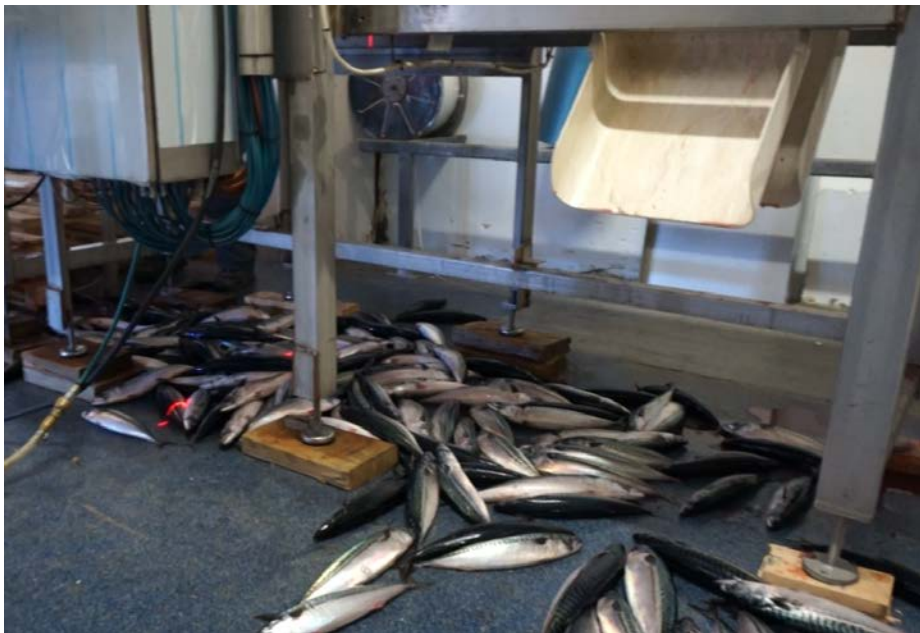
Figur 18: Fisk som ramlet av transportbåndet under kapasitetstesten.
