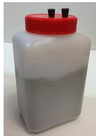
Figur 2. Boks til inkubering av prøver. Lokket har hull for flushing med CO 2
