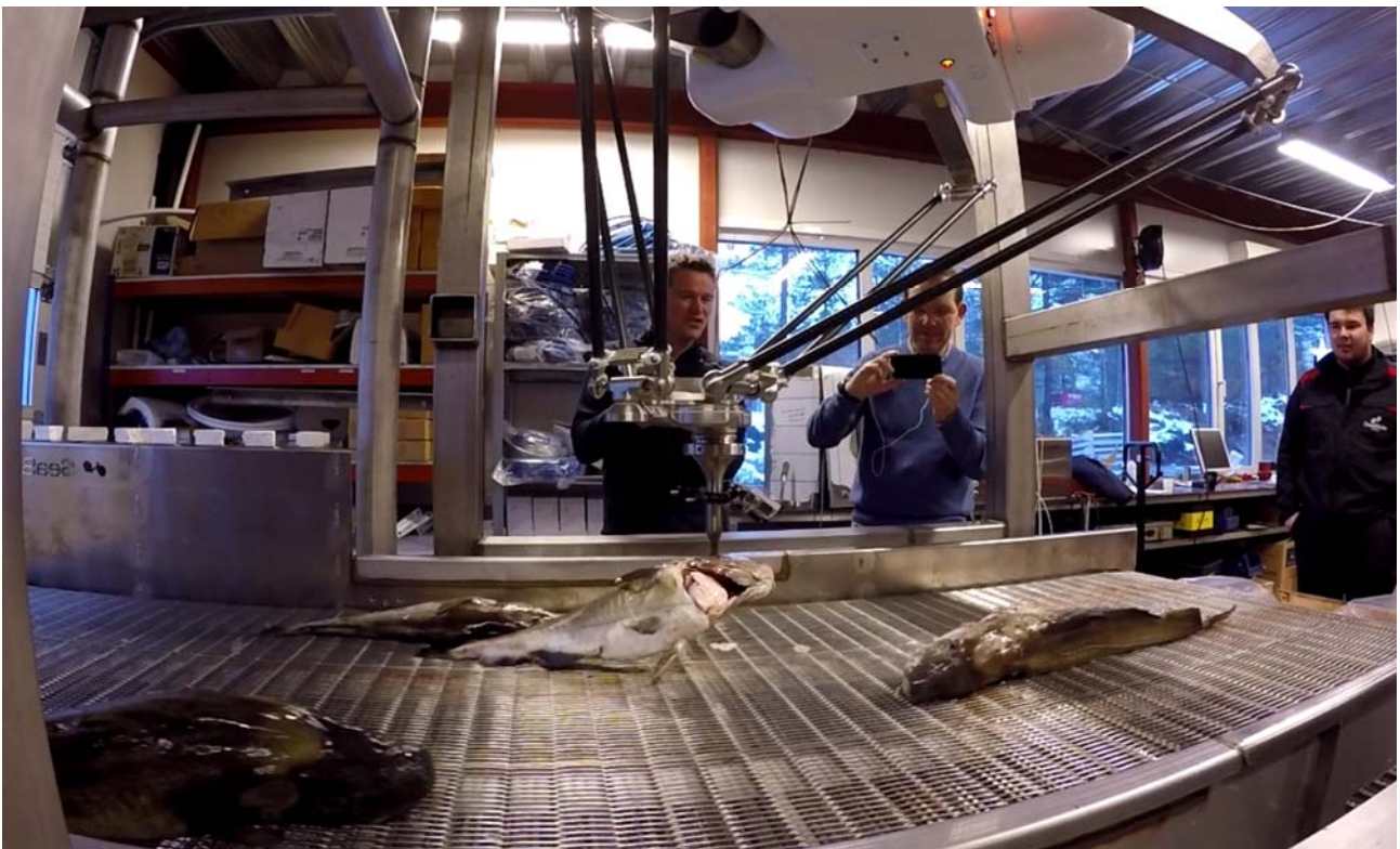
Figur 19: bilde fra testing, som viser en torsk som henger fast på kniven
