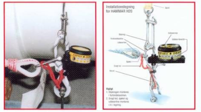
Korrekt montering af hydrostatisk udløser til redningsflåde
