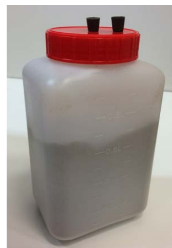
Figur 6: Prøveflaske med hull i lokk for tilsetning av CO 2 gass
