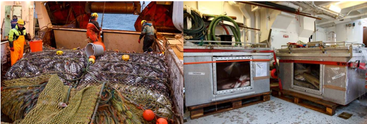
Uttesting av levendefisktank om bord på tråleren J. Bergvoll
