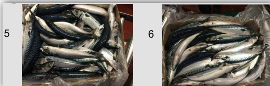
Figur.2 Bilde viser pakking fra linje-5 uten ensretter, og linje-6 med ensretter.
