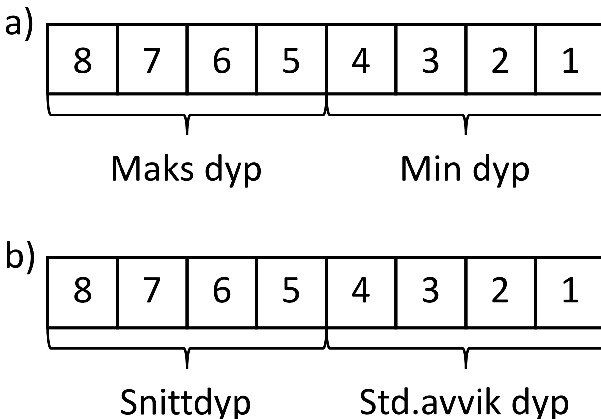
Figur 3: Oppbyggingen av databytes for sending av dybde data. a) byte som inneholder maks- og min-dybde, b) byte som inneholder snittdyp og standardavvik for dybde.
