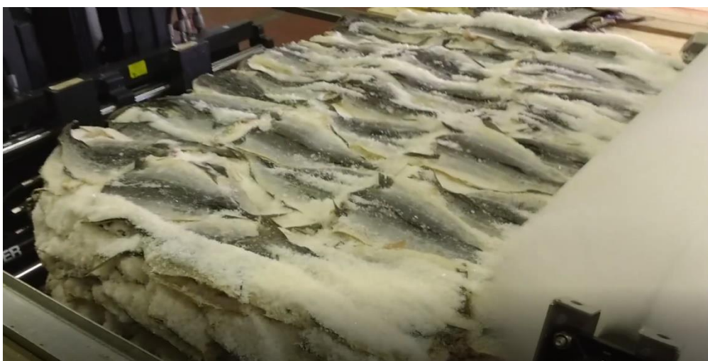
Figur 8 - Overflaten til fiske-pallen etter at børsteenheten har passert en gang.
