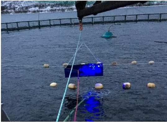
Fig. 16. Prototype-teine for utprøving av gjenfangst av rognkjeks i merd.
