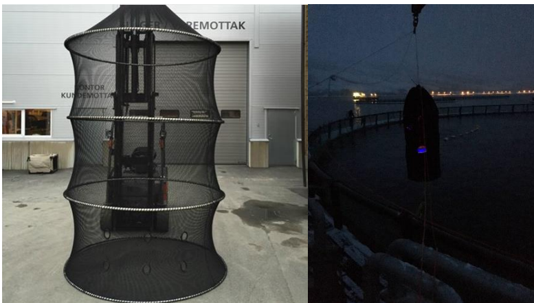
Fig. 17. Prototype-felle for utprøving av gjenfangst av rognkjeks i merd. Notpose kledd med barkduk og med innvendige LED-lys.
