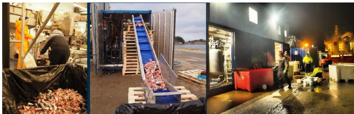
Figur 8. Manuell oppsamling av restråstoff inne ved produksjonslinjen, mating av restråstoff inn i kontaineren og hektisk aktivitet i Mobile Sealab.
