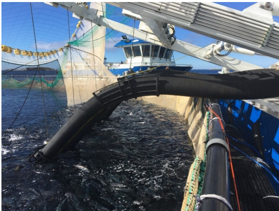
Figur 6 – Laks til avlusing pumpes fra avkast til Hydrolicer LG9332 Hydro i seks parallelle rørsystem.
