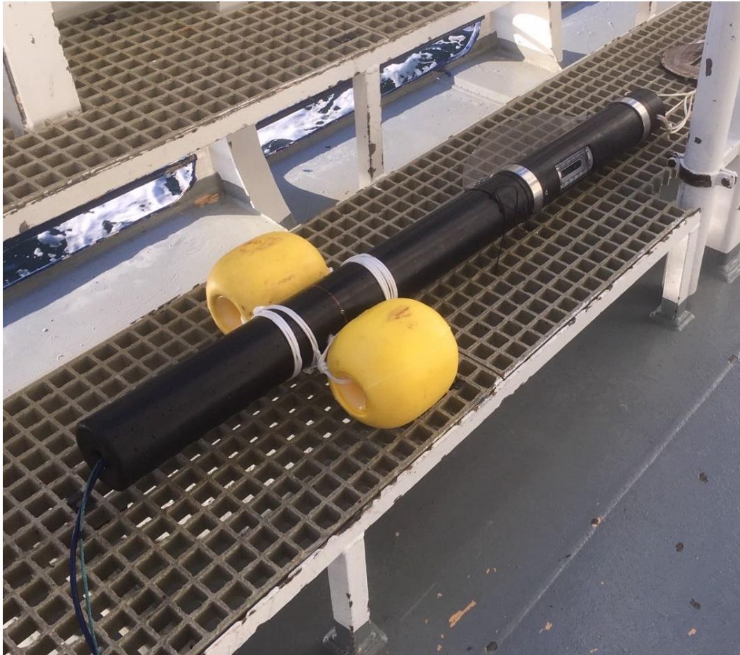
Figur 21 - Sonden «Stereo Catch Monitoring Probe» (S-CMP) klar for utplassering under forskningstoktet på M/S Fiskebas. Flytedelen og kameradelen er koblet sammen ved hjelp av en støttelinje, slik at dybden på kameraet kan kontrolleres i forhold til overflaten. Kabelen fra kameradelen er festet til støttelinjen og passerer gjennom flottøren. Denne versjonen er utstyrt med en Ethernet-kabel for direkte videostrøm fra sonden, samt ekstra ballast og flyt for å stabilisere kameraets vertikale posisjon i vannet.
