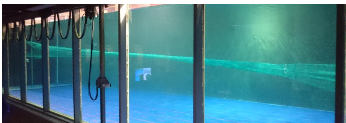
Sekkeforlengelse med 2 leistau. Viser trang overgang mellom snurrevad og sekk.
