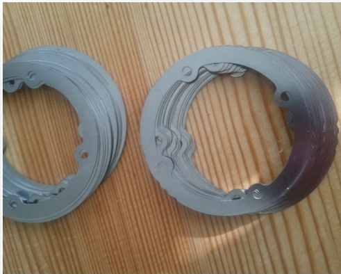
Bilde 7: Bildet viser distanser (mellanlägg) av härdad RF stål. Dessa fungerar som styrningar för grepporganen.
