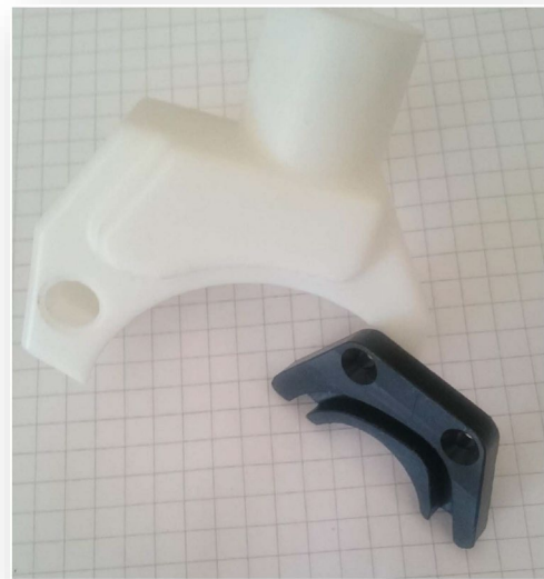
Bilde 10: Bildet viser vakuumpåpe og styrspår for Grepporgan (tidligere varianter).
