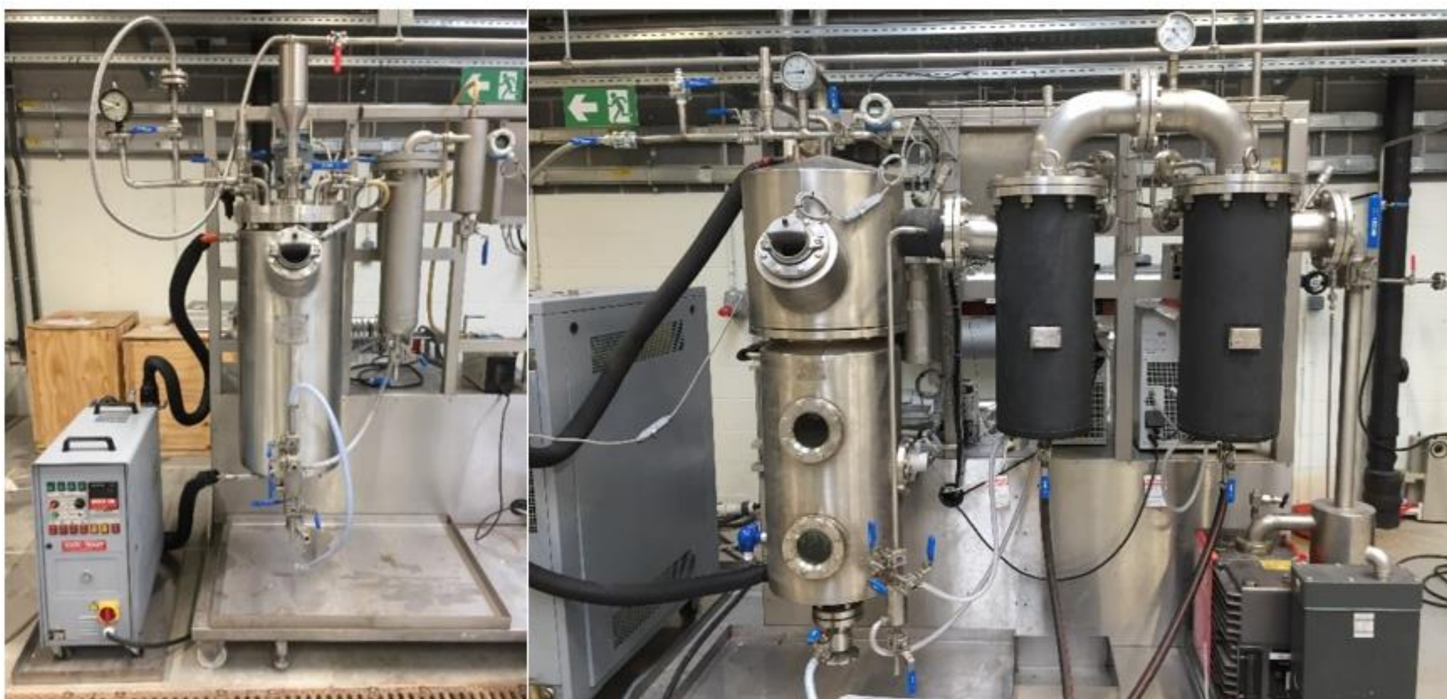
Piloskala raffineringssanlegg som ble benyttet i prosjektet, blekeanlegg (til venstre) og deodorisator (til høyre). (TERRA TRC, Gembloux, Belgia).
