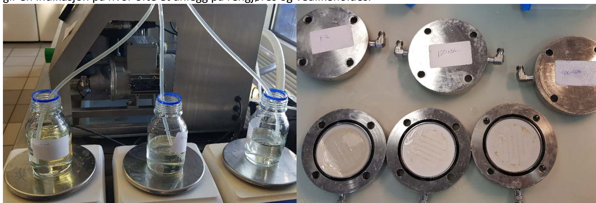
Figur 9: (1) Laken som kommer ut er lys og klar, (2) Bildet viser "fouling" på membranfilteret
