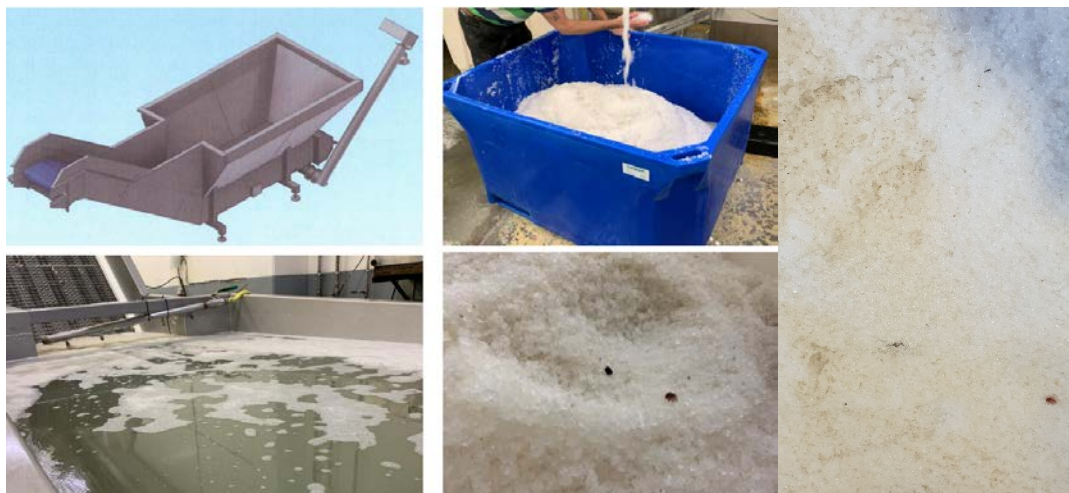
Figur 2: Skruetransportør for utvinning av uløst salt og bilde av salt før vask.
