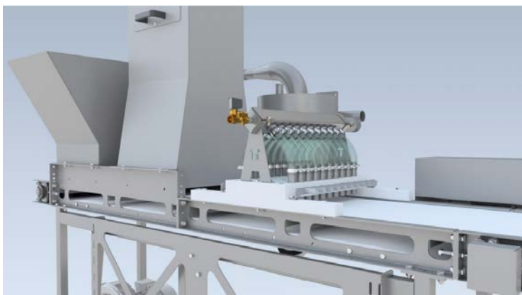
Figur 5: Dyser som suger opp underliggende partikler.
