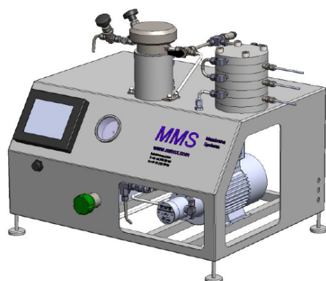
Figur 7: Forsøksoppsett for rensing av saltlake
