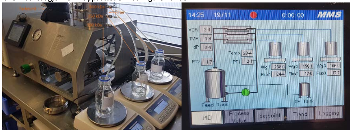
Figur 8: Praktisk gjennomføring av membranfiltrering hos MMS. (1) viser oppsettet hos bedriften og (2) viser skjematisk oversikt over prosessen
