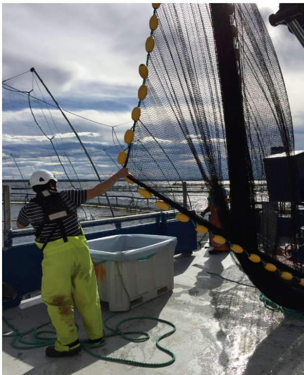
Illustrasjon 2: Orkastnot som skal brukes til prøvetaking. På dekk står bedøvelseskaret (foto: SINTEF Ocean).
