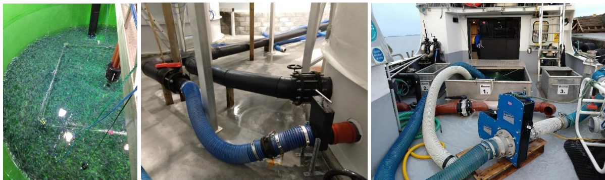
Første trinn i fisketransporten, overføring fra kar til brønnbåt; nedtapping av kar (trenging) og transport av fisk i rør fra kar til båt via fisketeller.
