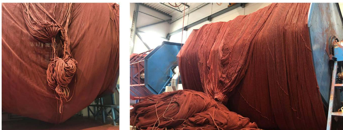
Figur 24 Kobberimpregnerte nøter (rødfargen)
