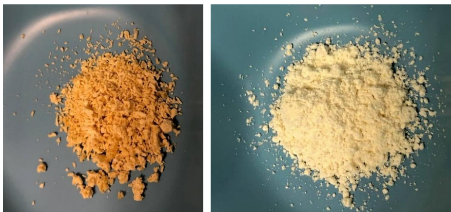
Figur 6 Eksempel på resultat fra spraytørking; venstre Bromelain hydrolysat pulver uten eksipient og smaksmaskering, høyre Bromelain 1:1 med gum arabic.
