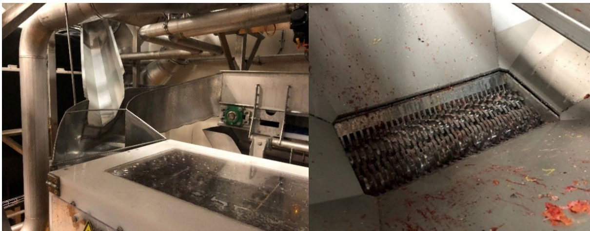
Figur 3 Venstre bilde: Innmating av fisk til Stansas destruksjonsbedøver, innmating til venstre er for småfisk fra avsilingskasse, mens høyre er fra manuell utsortering fra slakteriggen. Høyre bilde: Viser en GS 150 tannkvern.
