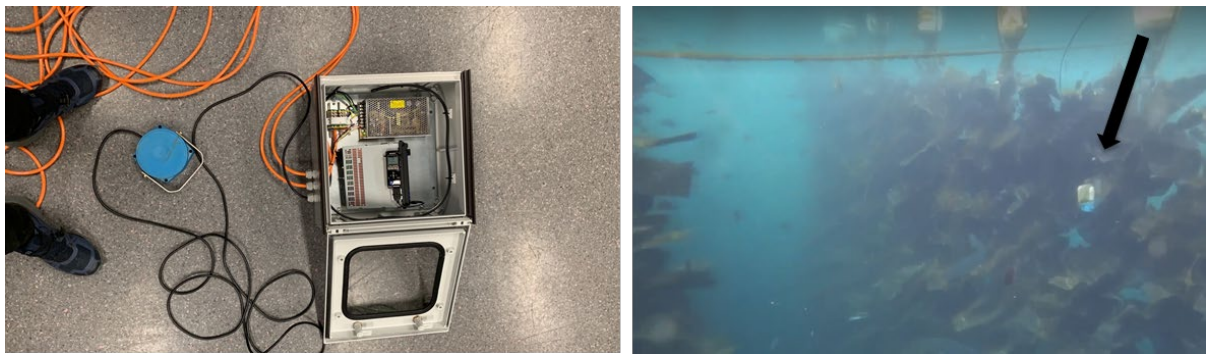
Figur 11. Styringskap med undervannshøytaler (venstre) og plassering av høytaler i rensefisk-skjul (høyre).
