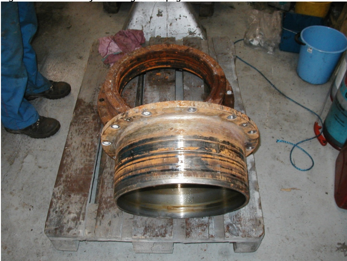
Figur 4-39 Liner til hylsetetning for skrog i modifisert karbonstål
