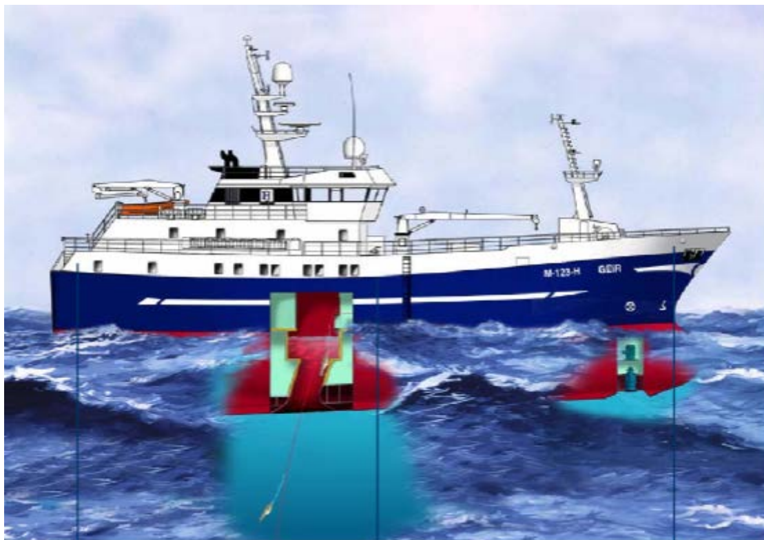
Figur 4-17 Illustrasjon av en dragerbrønn (Sintef Fiskeri og Havbruk)
