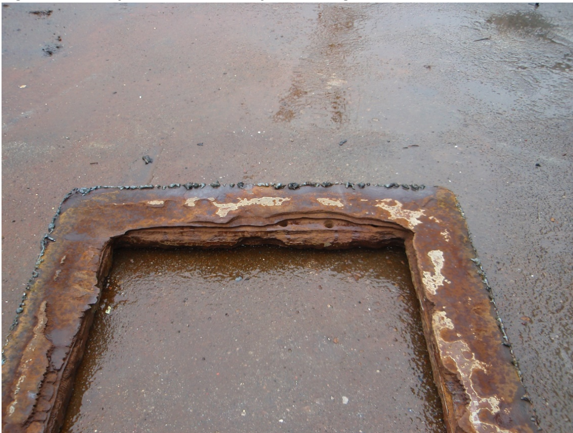
Figur 4-25 Karbonstålflens som er fjernet fra sjøkisten ved hjelp av flammekutting i Figur 4-23
