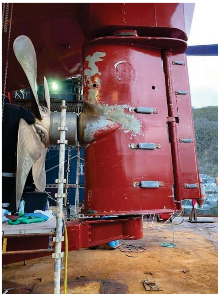
Figur 19. Plassering av anoder på ror
