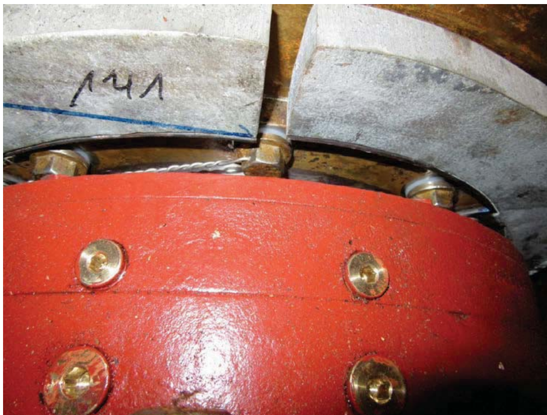
Figur 22. Reparert hylsetetning med sinkanoder
