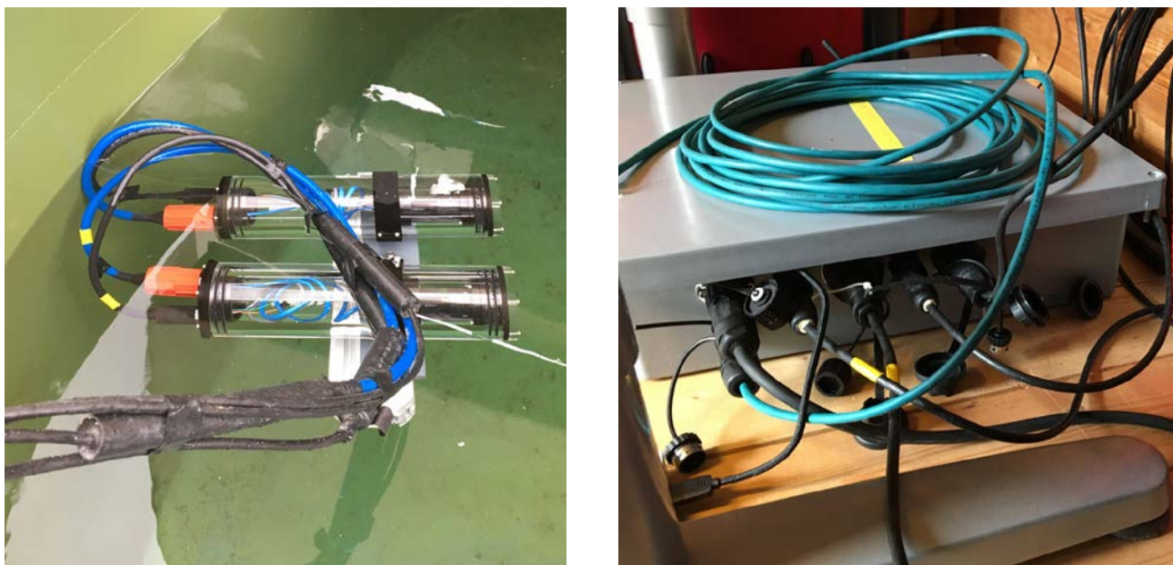
Figur 26: Figuren viser stereokamera (til venstre) og kabinettet (til høyre) med kontrollenhet, som brukes for observasjon av laksen i en av tankene ved Ims forskningsstasjon.
