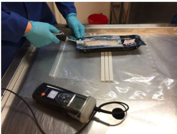
Figur 7: Kontrollmåling av kjernetemperatur i loins etter tining
