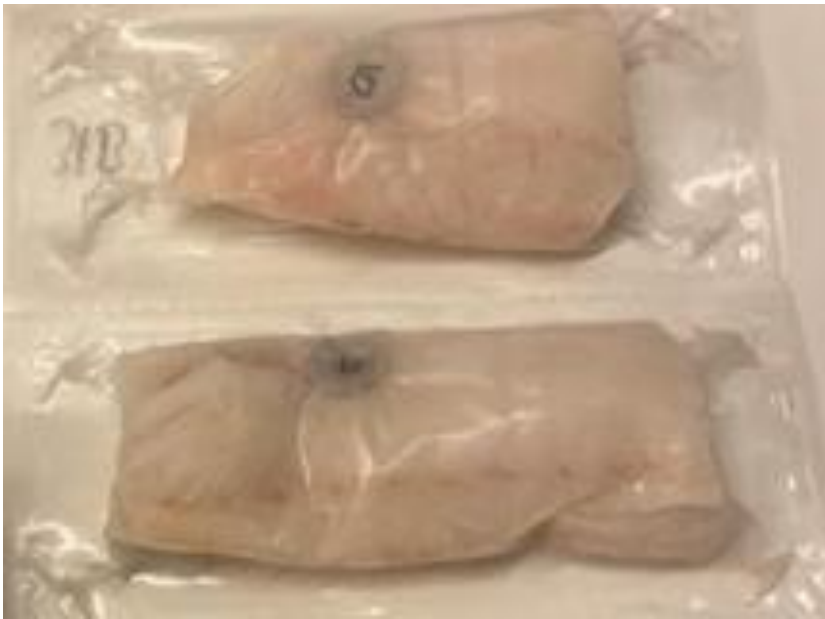
Figur 3: Plassering av knappeloggere (iButton) i bunnen av pakken.
