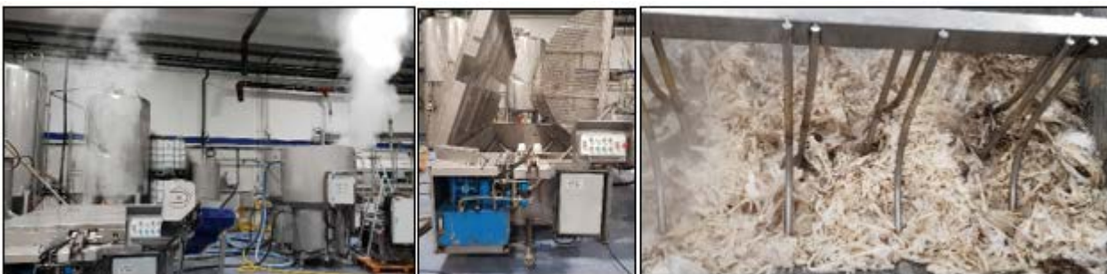
Figur 2: En liggende, nyutviklet, hydrolysereaktor ble testet i PRIMAProtein prosjektet.
