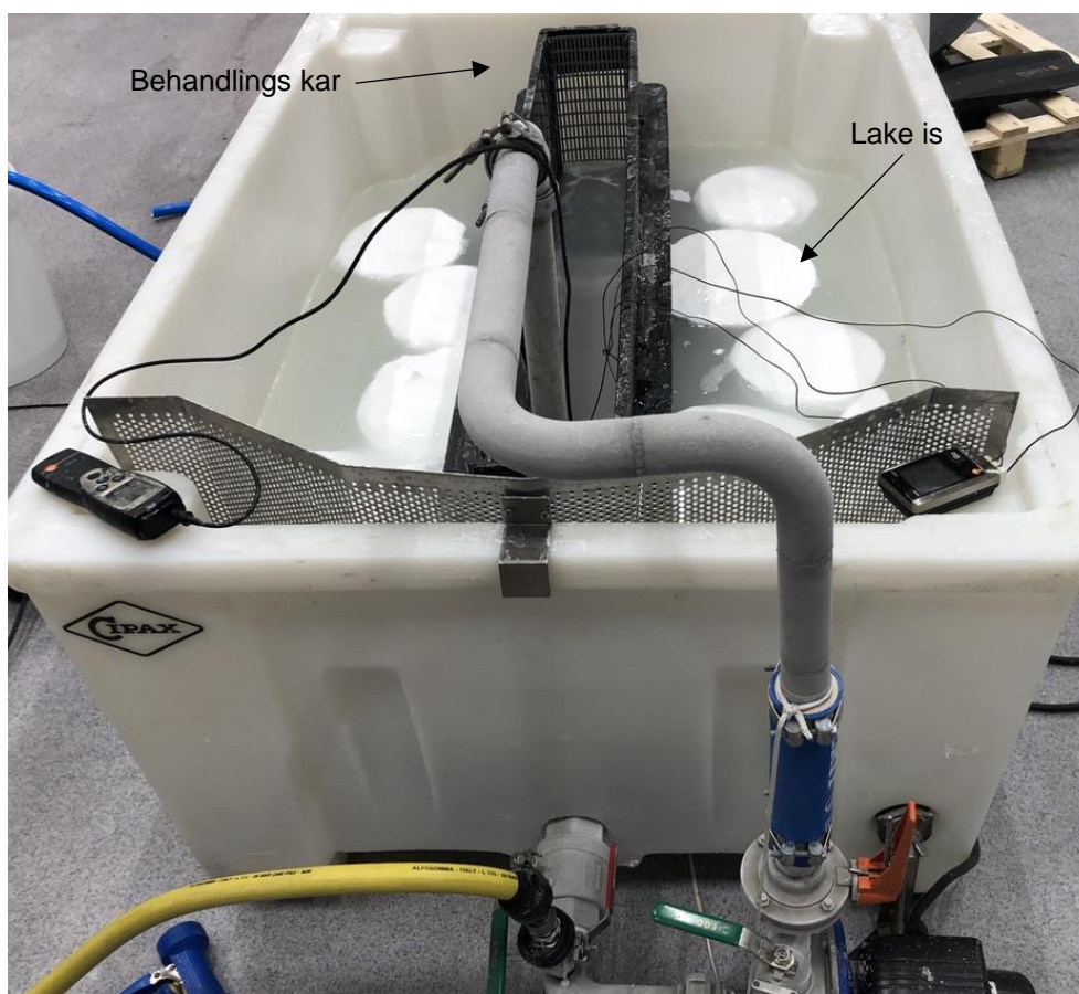
Figur 1 Apparatet som ble brukt til bedøving ved ultra-lav temperatur. Underkjølt lake med lake-is blir pumpet fra det største (hvite) karet inn i et smalere behandlingsskar (i midten, svart). Under forsøk ble all lake-is lagt på den ene siden av behandlingsskaret.
