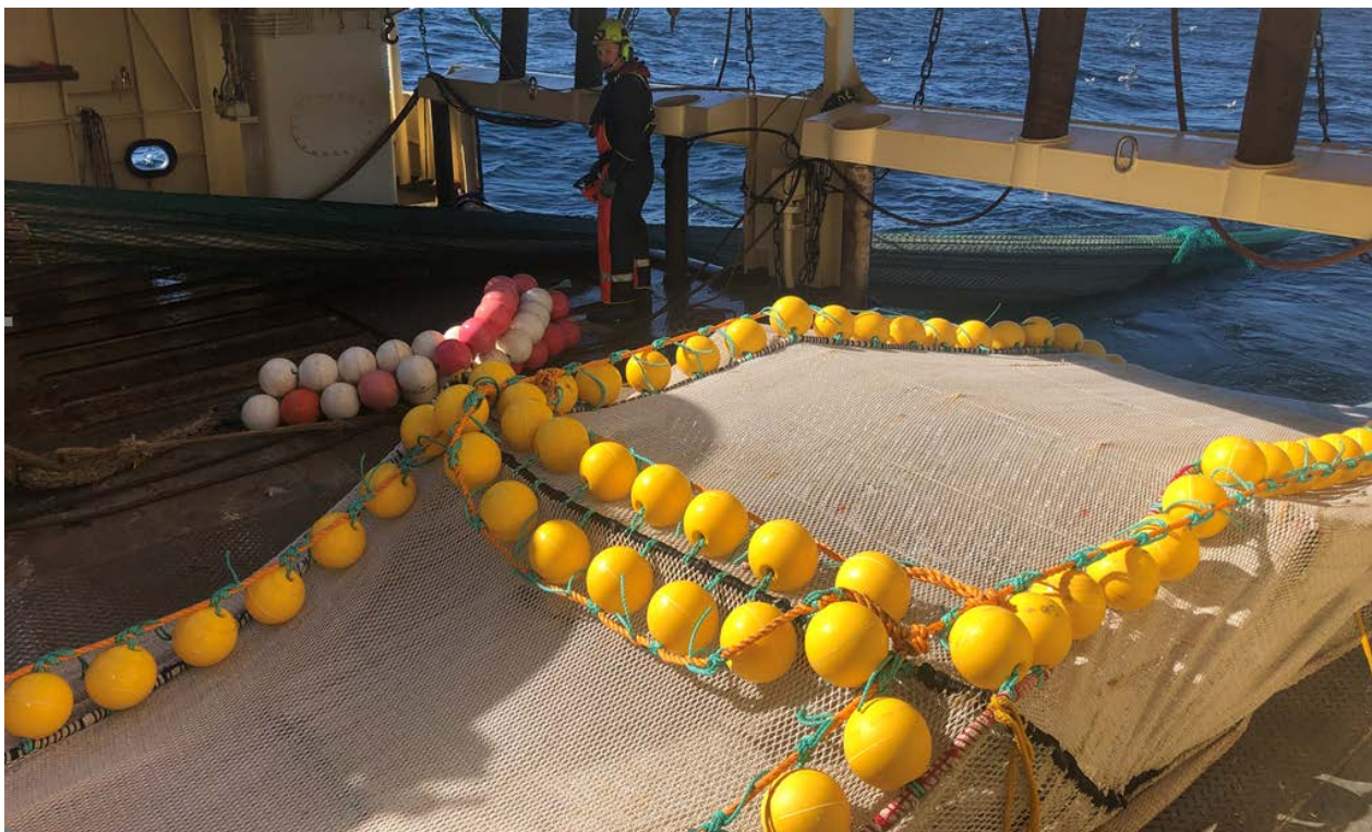
Figur 12. Bilde av den store risten som er 2,7 m bred og 3,6 m lang.
