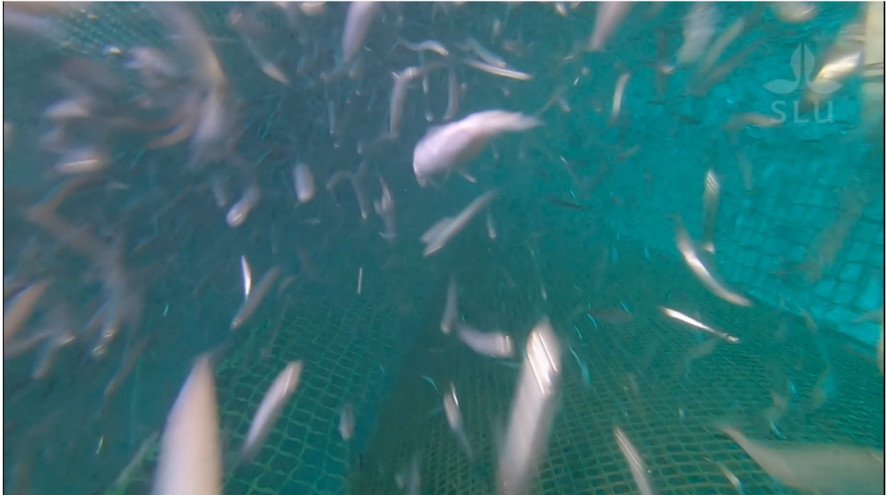
Figur 24: Bilde av tobis som går gjennom kvadratmaskene og havner bak i sekken.
