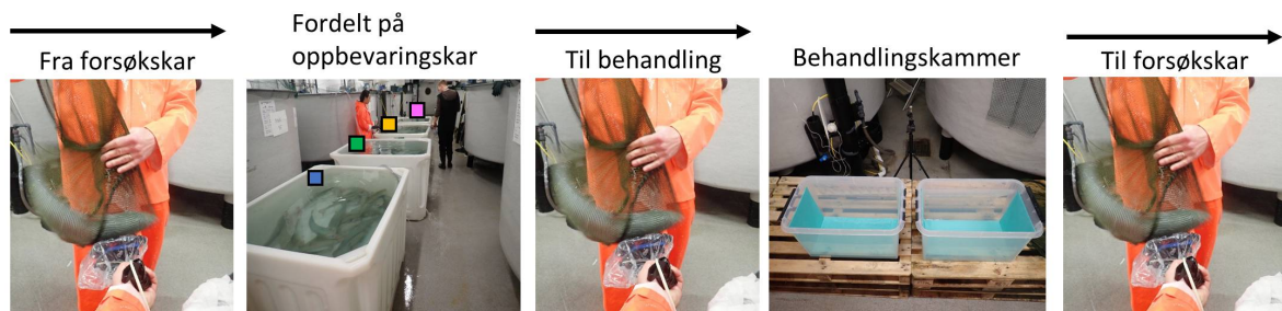
Figur 4. Fisk fra hvert forsøkskar ble først fordelt på 4 oppbevaringskar basert på fargen på det utvendige T-bar merket, deretter ble de enkeltvis håvet videre til behandling på enten 14, 27, 30 eller 33 °C før de ble returnert tilbake til det opprinnelige forsøkskaret.
