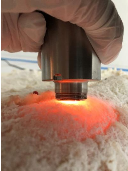
Figur 4 Måling med håndholdt VIAVI MicroNIR.
