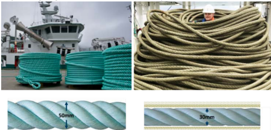
Bilde 1: Nytt snurrevadttau (til venstre) og brukt (kassert) snurrevadttau (til høyre).
