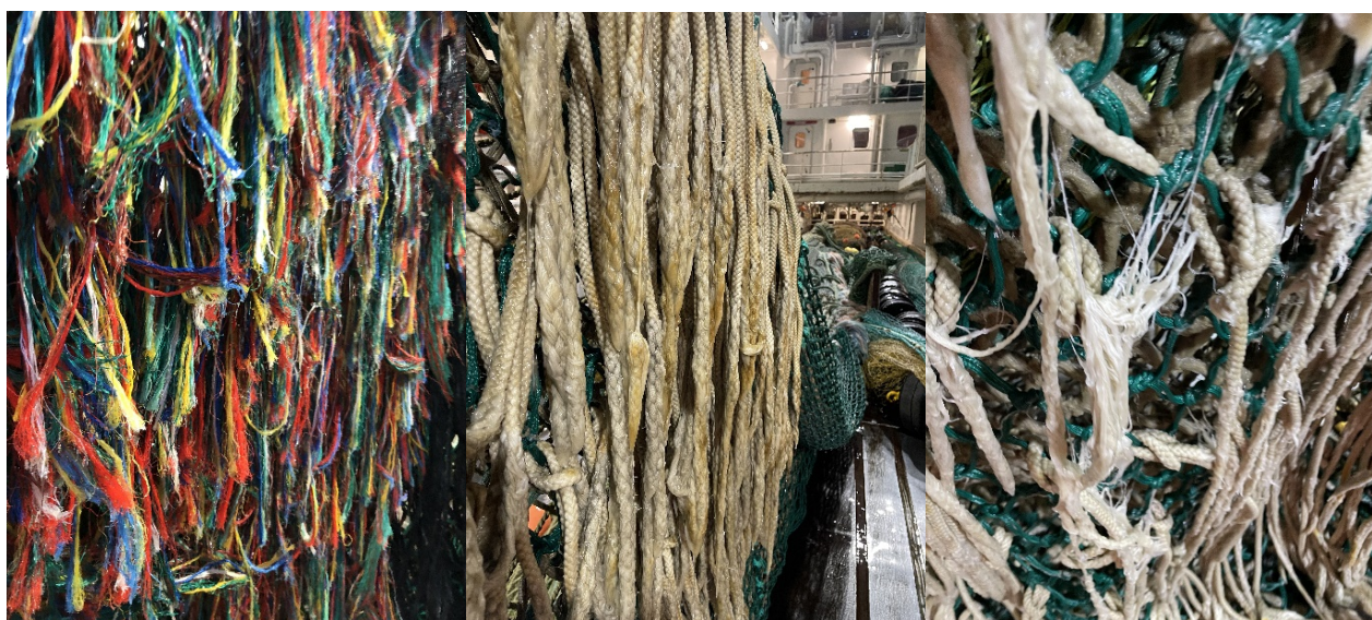
Bilde 22. Nærbilder av labbetussene mot slutten av testserien. Slitasje av ulik karakter (Bilde: Simon Eliseussen).
