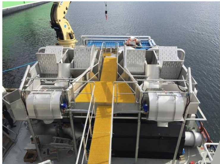
Figur 4: Optilicer med varmtvannsbad og to separate skovlehjul. Skovlejhjulene skyver fisken gjennom et lite kar med oppvarmet sjøvann. Består av en oljebrenner som varmer opp vannet, behandlingskar, CO 2 -utlufting og oksygenering. Vannet avsiles gjennom et trommelfilter som filterer ut lus og egg. Bilde fra: (Roth, 2016)
