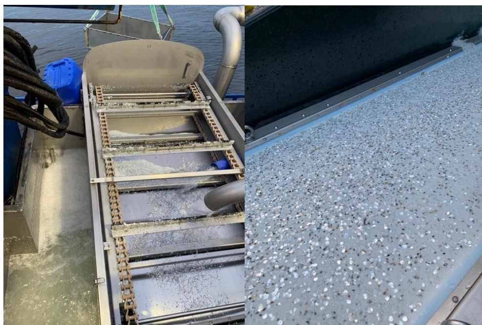
Figur 6: To ulike filter for oppsamling av lus under behandling. Til venstre: Trommelfilter (150 µm) på SkaMik som filtrerer ut lus og skjell fra vannet i et oppsamlingskar. Til høyre: Oppsamlingsfilter på Optilicer som filtrerer ut lus som faller på båndet og blir ført til et oppsamlingskar. Bilde fra: Mikael Furberg, 2021
