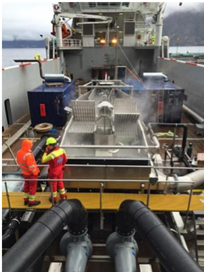
Figur 4: Optilicer med varmtvannsbad og to separate skovlehjul. Skovlejhjulene skyver fisken gjennom et lite kar med oppvarmet sjøvann. Består av en oljebrenner som varmer opp vannet, behandlingskar, CO 2 -utlufting og oksygenering. Vannet avsiles gjennom et trommelfilter som filterer ut lus og egg. Bilde fra: (Roth, 2016)
