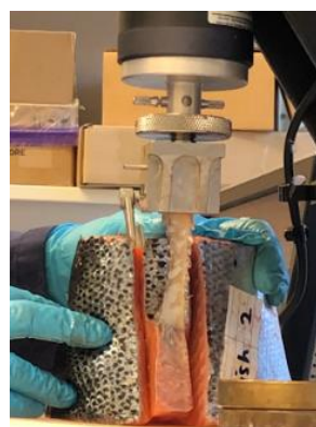
Figur 2. Bilde som viser mekanisk analyse av skinnfeste, målt som kraften som trengs for å dra av skinnen
