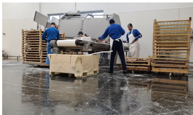
Omleggingstrommelen bidrar blant annet til at mengden salt på golvet er kraftig redusert.
