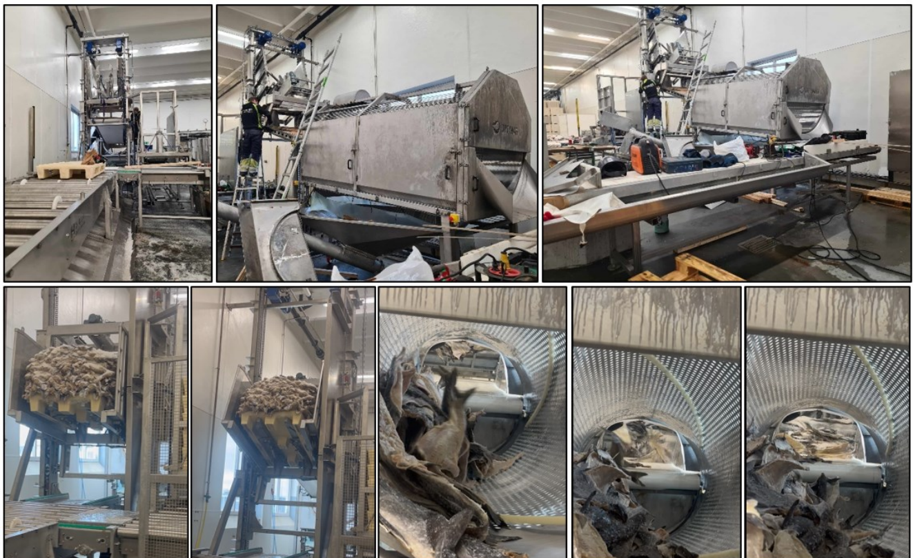
Bildene viser installasjon, testing og tilpassing av produksjonslinje for effektiv omlegging av liten klippfisk hos ScanProd AS. Bildene under viser en palle med fisk på vei opp heisen, og etterpå vendes den inn i trommelen i to deler. Den øverste delen av fisken splittes fra nedre del av pallen, slik at trommelen kan mates med riktig mengde fisk.
