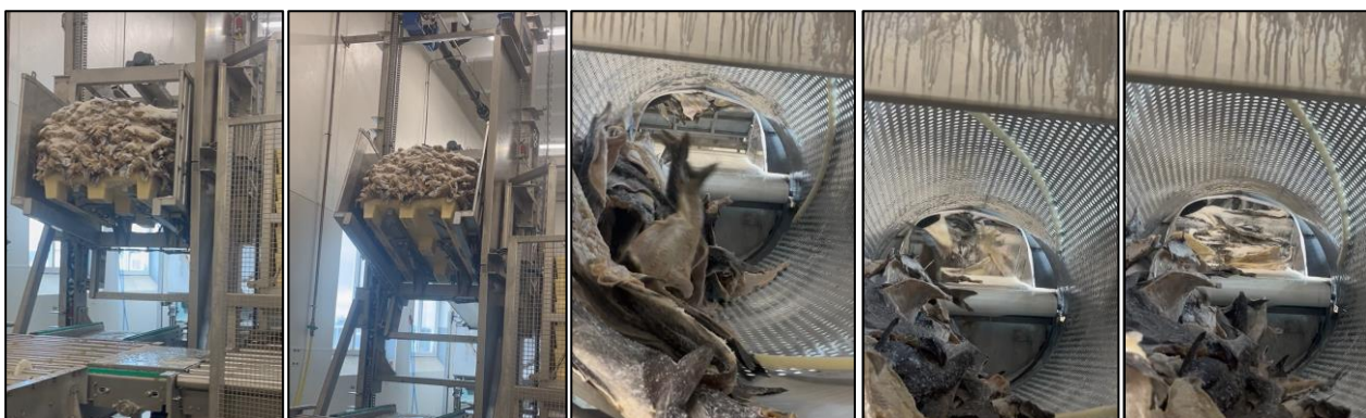
Bilde 7: Bildet viser en palle med fisk på vei opp heisen, og etterpå vendes den inn i trommelen i to deler. Den øverste delen av fisken splittes fra nedre del av pallen, slik at trommelen kan mates med riktig mengde fisk.
