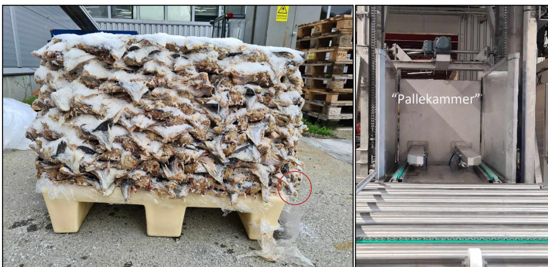
Bilde 3: Fisk på pallen stikker utenfor. Dette medførte at pallen med fisk ikke passet inn i «pallekammeret».
