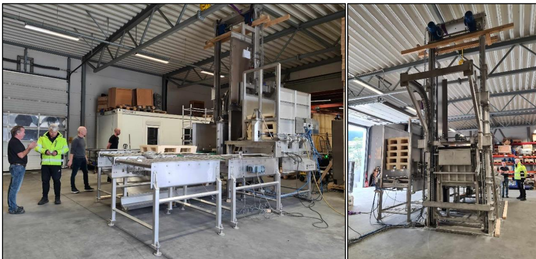
Bilde 2: Bildene viser palleheisen for saltfiskpaller.
