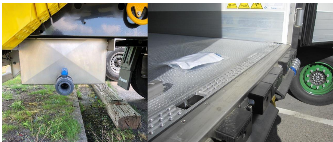
Bilde 2 Til venstre: Oppsamlingstank montert på Krone tralle med kapasitet på 255 liter. Til høyre: Oppsamlingsrist montert bakerst på en tralle, med avløp midt på tralla (Foto: Vogn-Service AS)
