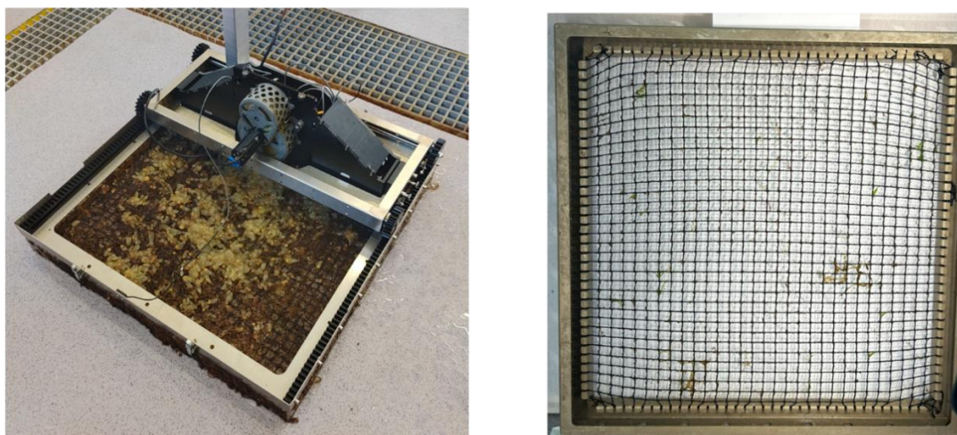
Figur 11. Til venstre er det bilde av overgrodd testpanel og børste-modul. Testpanelet ble plassert i en tank med sjøvann der de ble rengjort med en børste-modul eller en spylemodul. Til høyre er det bilde av et testpanel etter 3 uker i sjøen. Det var lite begroing.
