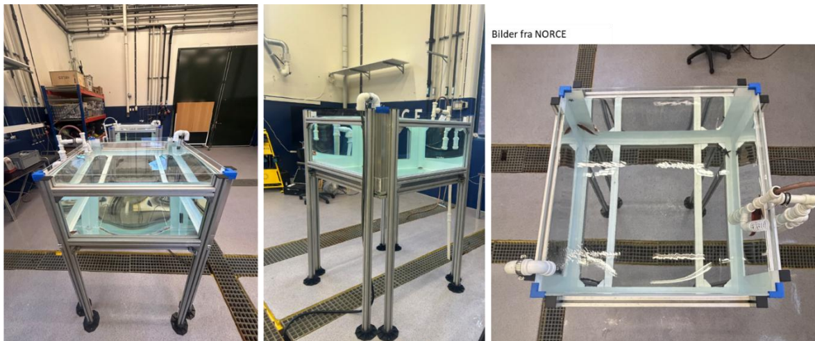
Figur 33. Fototank laget for å lage time-lapse video når groe vaskes av testpaneler. Man kan sammenligne ulike typer av børste- og spyleteknologi for å sjekke hvilken som er mest effektiv på ulike typer nett under kontrollerte betingelser. Bilder kan tas hver gang børsten eller spylerriggen passerer over nota.
