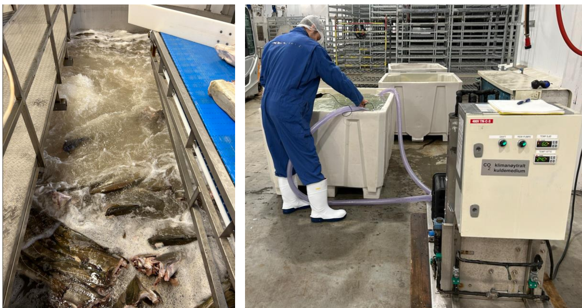
Figur 4: Industriell tining av blokker i tank (t.v.) og tining av singel-fisk i kar med RSW (t.h.)
